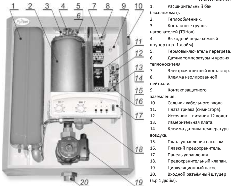
Рис.1. Состав отопителя.
