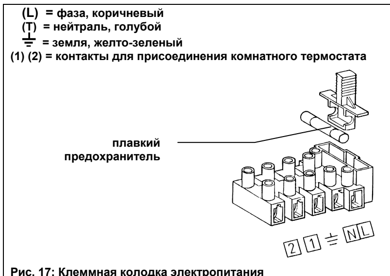
Рис. 17: Клеммная колодка электропитания
