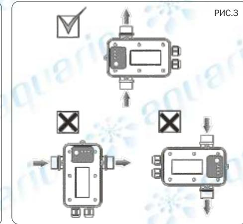
**Внимание:** Допускается только вертикальная установка реле выходным патрубком вверх. В любом другом положении оно не будет функционировать (рис.3).
