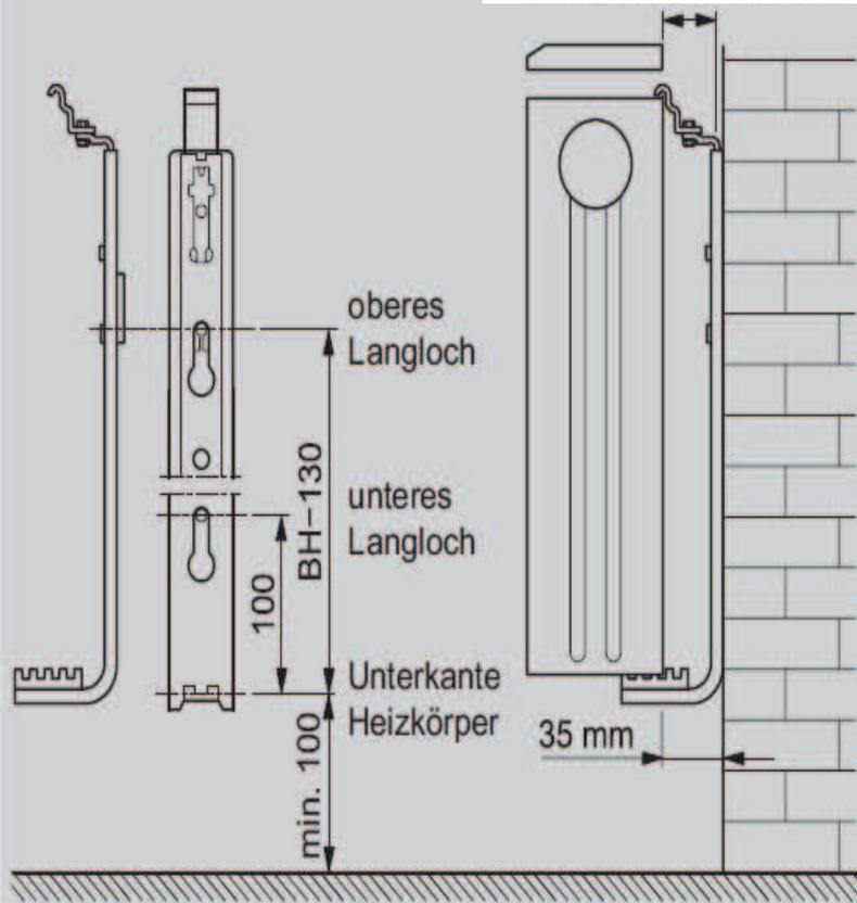
Монтаж на стене (крепление пружинных консолей при помощи анкерного комплекта)
