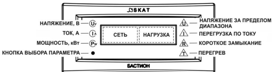
Рисунок 2 - Индикация и органы управления
