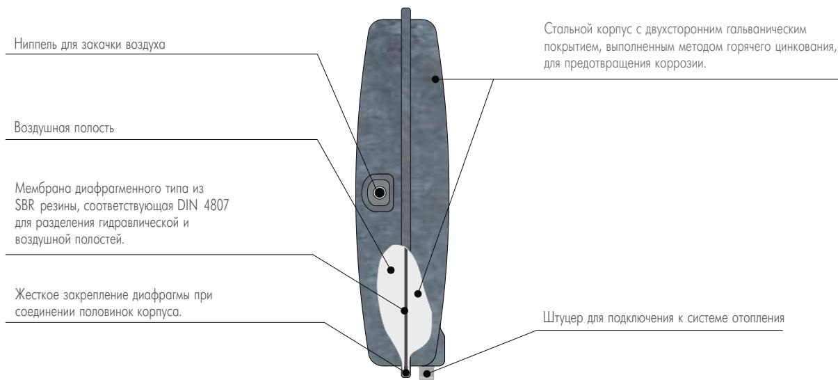
Расположение соединительного штуцера и ниппеля закачки воздуха может быть изменено при заказе. Резьба соединительного штуцера оговаривается при заказе. По запросу возможна порошковая окраска корпуса.
