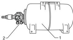
В комплект поставки входят следующие основные узлы: гидроаккумулятор (1) (5 или 24 л), устройство PM/5-3W (2) (объединяющее реле давления, манометр, штуцер), обратный клапан, переходник для шланга.
